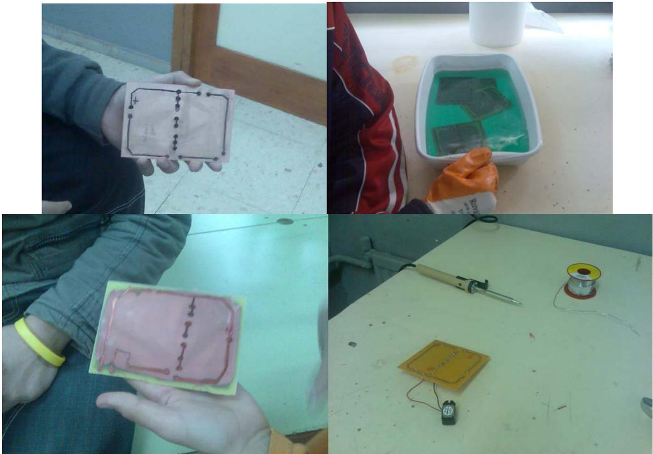
Figura 1. Diseño y construcción de una placa de circuito impreso.
